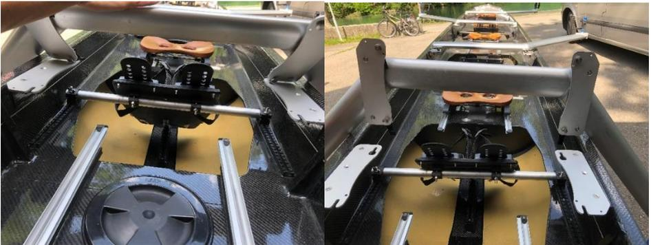
Schritt 2: Ausleger einfädeln und Richtung Bug schieben bis die Platten bündig aufeinander liegen.
